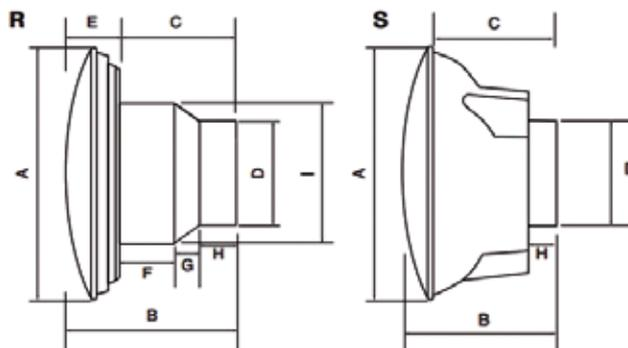
**R: montaggio ad incasso**    **S: montaggio a sbalzo**
