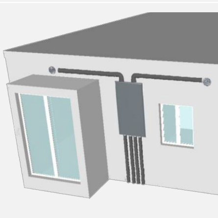
Installazione incasso esterno con presa esterna ed espulsione canalizzata Solo per taglie 10 e 15
